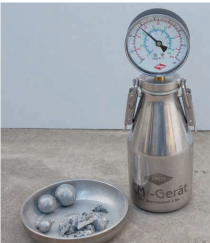
Bestimmung der Restfeuchte mit der CM-Messung
